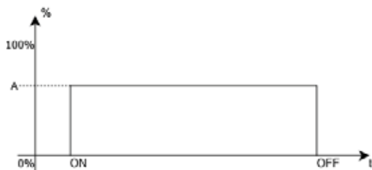
A Maximal fläkthastighet (Fabriksinställning - Ventilation)
